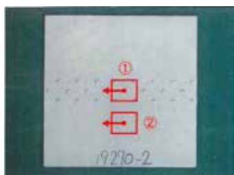
試験箇所 (ZAM 鋼) ①ノンスリップ仕様アンクル ②通常のアンクル
